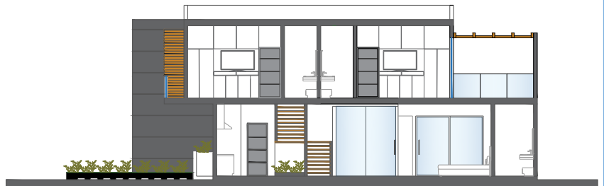
SECCIÓN B-B'/SECTIONAL ELEVATION B-B'
